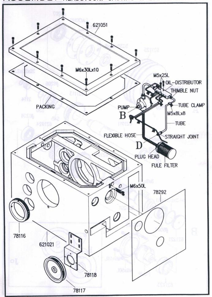
ASSEMBLY HEADSTOCK: SHAFT, GEAR, & PULLY
